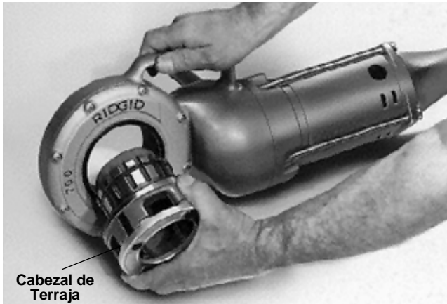
Figura 3 – Instalación del Cabezal No. 12-R
